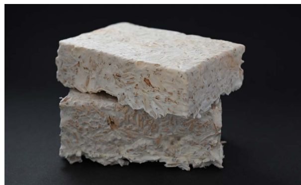
Komposite aus Holzfasern und Pilzmyzel als „Bindemittel“ sind recyclingfähig bei Bedarf vollständig biologisch abbaubar.
