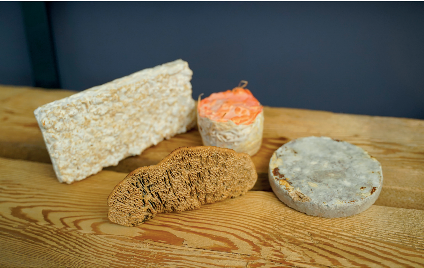
Wachsende Materialien: Myzel-Komposite aus diversen Pilzarten auf Altholz und Holzwolle. Vorne ein Baumpilz, der aktuell auf seine Eignung für neue Myzel-Werkstoffe untersucht wird.
