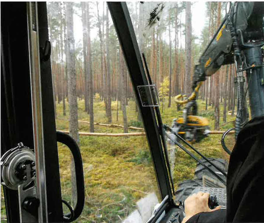
Abb. 6: Bei der Variante HZ hat der Harvester die zugefällten, mittelstarken Kiefernstämmе vom Zopf her aufgearbeitet.
