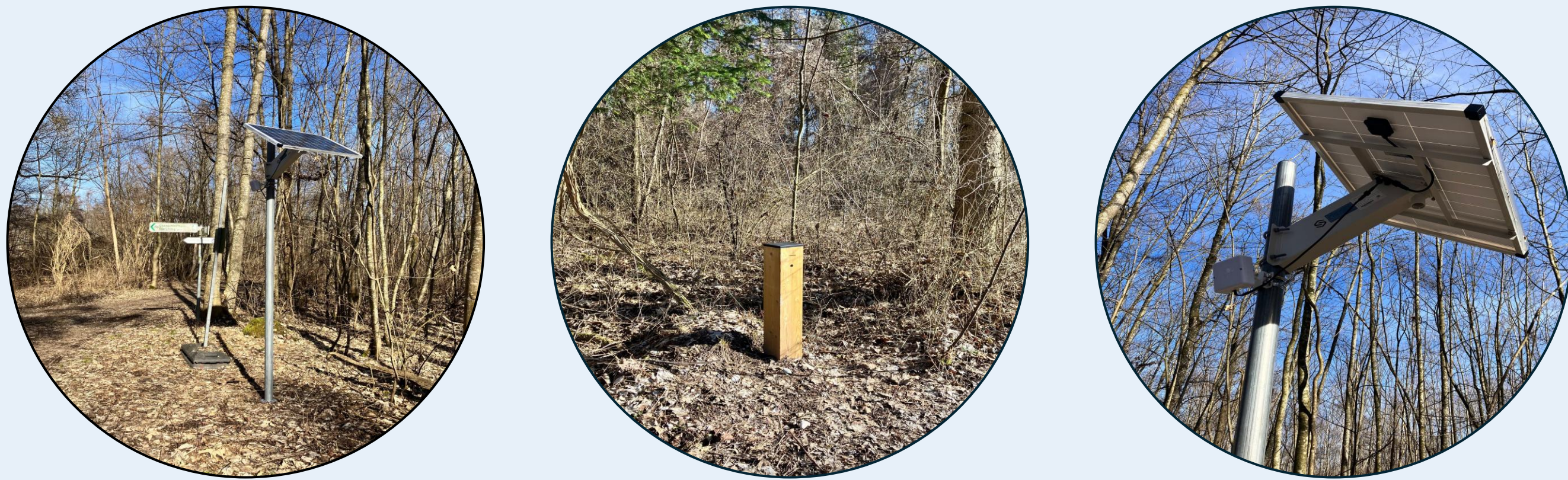
Abb. 1: Zähler (Sensmax, Eco-Counter) zur Besucherzählung im Projektgebiet
