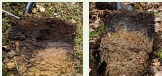
Abb. 3 und 4: Spatenproben stark versauerter Oberböden mit erkennbarer Säurebleichung
