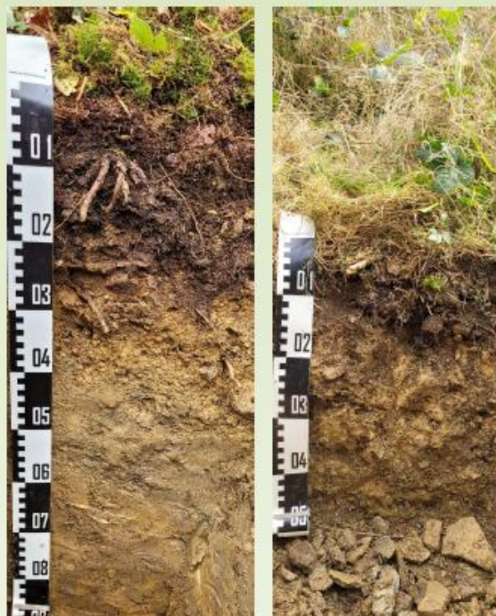
Abb. 1 und 2: Bodenprofilenaufnahmen eines Braunerde-Pseudogleys (links) und einer Braunerde (rechts) im Amsberger Wald mit Rohhumusauflage
