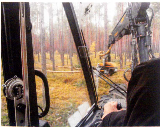
Abb. 4: Bei der Variante HZ40 hat der Harvester eine hohe Leistung erbracht, weil er die gezopften Stämme zügig aufarbeiten konnte
